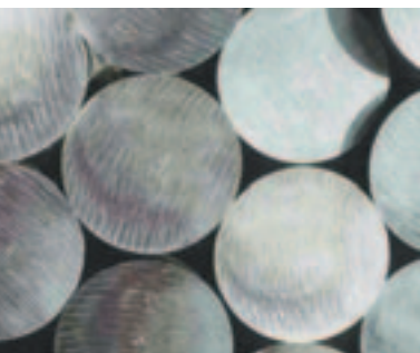
Bei dem INCAL-Verfahren von Messer werden Aluminiumblöcke mit Stickstoff gekühlt und durch Matrizen gedrückt.
