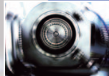
Eine gegenläufige Stiftmühle ist das Herzstück des neuen Kaltmahltechnikums in Willich, Deutschland, das seit März 2005 Kunden für Mustermahlungen zur Verfügung steht.
