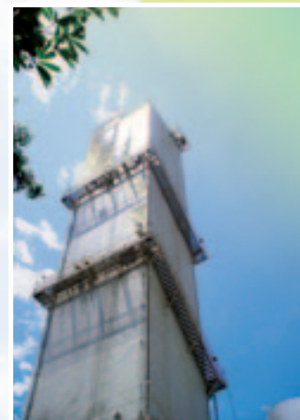
Mitte Juni 2005 wurde in Hunan, China, eine neue Luftzerlegungsanlage von XMG in Betrieb genommen. Sie verfügt über eine Tageskapazität von 550 Tonnen (siehe auch Seite 60).
